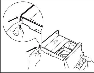
2. Retirez l'insert pour l'assouplissant et, s'il est en place, le récipient pour la lessive liquide.
