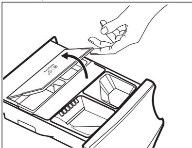
3. Versez doucement de la lessive liquide uniquement dans le réservoir de lessive AutoDose
