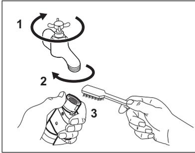
2. Retirez le tuyau d'arrivée de l'appareil en desserrant la bague de serrage.
