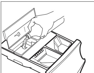
4. Versez doucement un assouplissant liquide uniquement dans le réservoir d'assouplissant AutoDose
