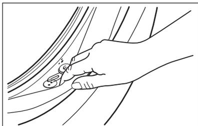
Si nécessaire, nettoyez-le en utilisant un agent nettoyant à l'ammoniaque et sans érafler la surface du joint.
