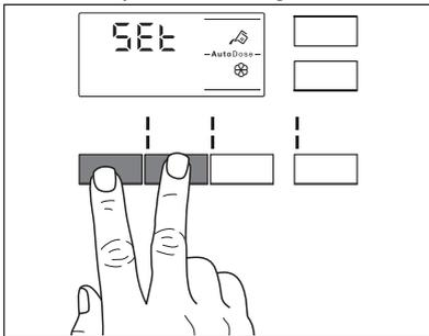
4. Appuyez sur les touches correspondant aux réservoirs pour activer et désactiver la fonction. OFF s'affiche lorsqu'un réservoir est désactivé ou le voyant du réservoir s'affiche lorsqu'il est activé.
