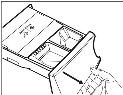
2. Versez le produit de lavage en poudre dans le compartiment
