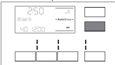
5. Pour régler le dosage de base, appuyez sur les touches correspondant aux réservoirs jusqu'à ce que le dosage de produit de lavage et deux flèches s'affichent en bas de l'écran. Appuyez à plusieurs reprises sur la touche Température pour augmenter le dosage et sur la touche Option pour le diminuer. Le minimum est de 1 ml.
