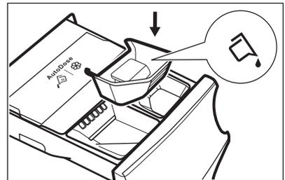
**i** Si vous utilisez un détergent liquide, assurez-vous que le **bac spécial pour le détergent liquide** est inséré. Reportez-vous au paragraphe « Remplissage manuel du produit de lavage et des additifs » dans ce chapitre. Le bac pour la lessive liquide se trouve à l'intérieur du tambour.
