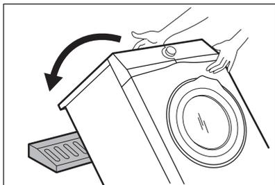
7. Retirez la protection en polystyrène en bas de l'appareil.
